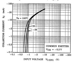
Fig. 10.6 RN2406 I<sub>C</sub>-V<sub>I(ON)</sub>
